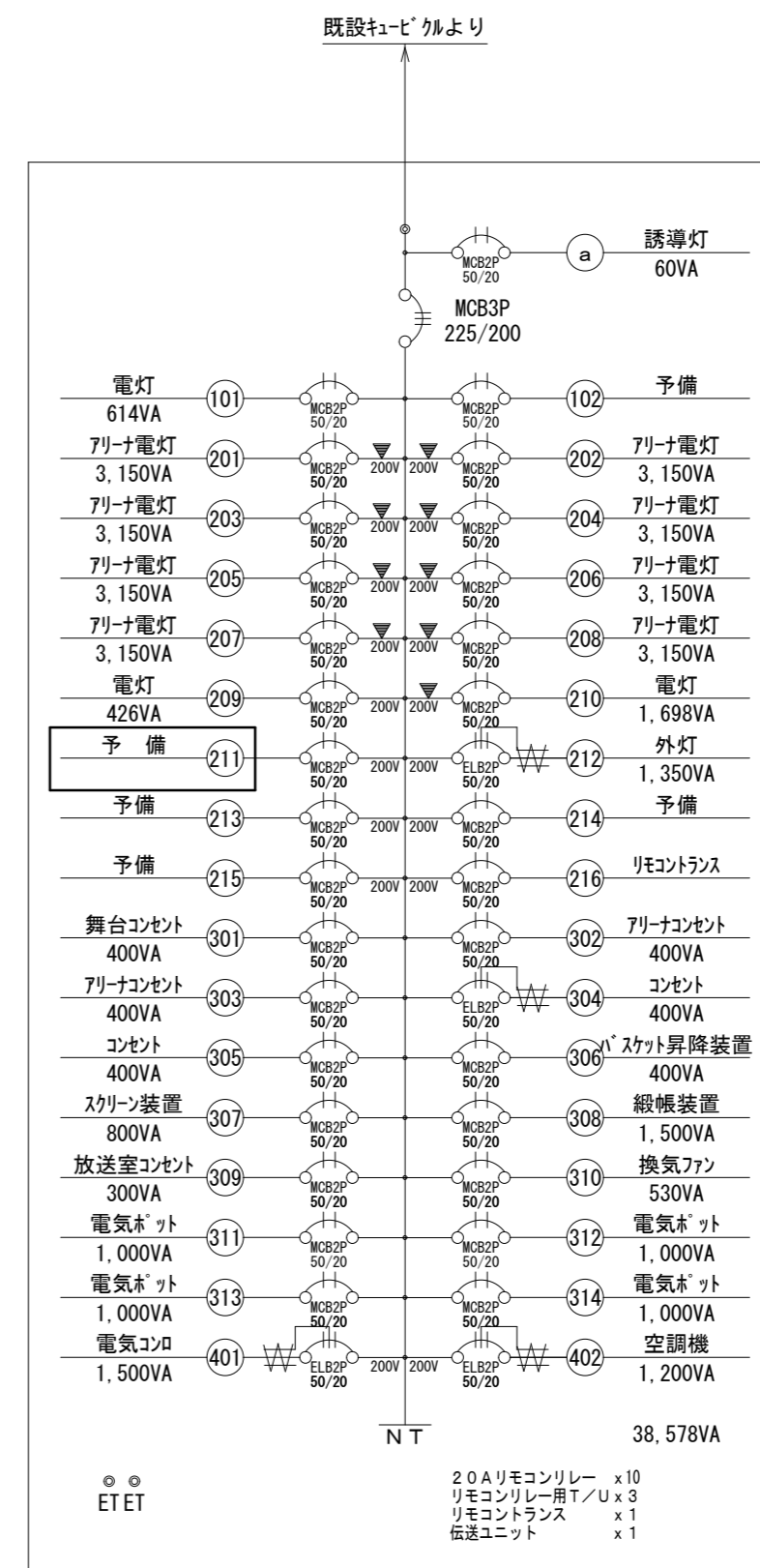
【改修後】 既設電灯盤(L-TA)
