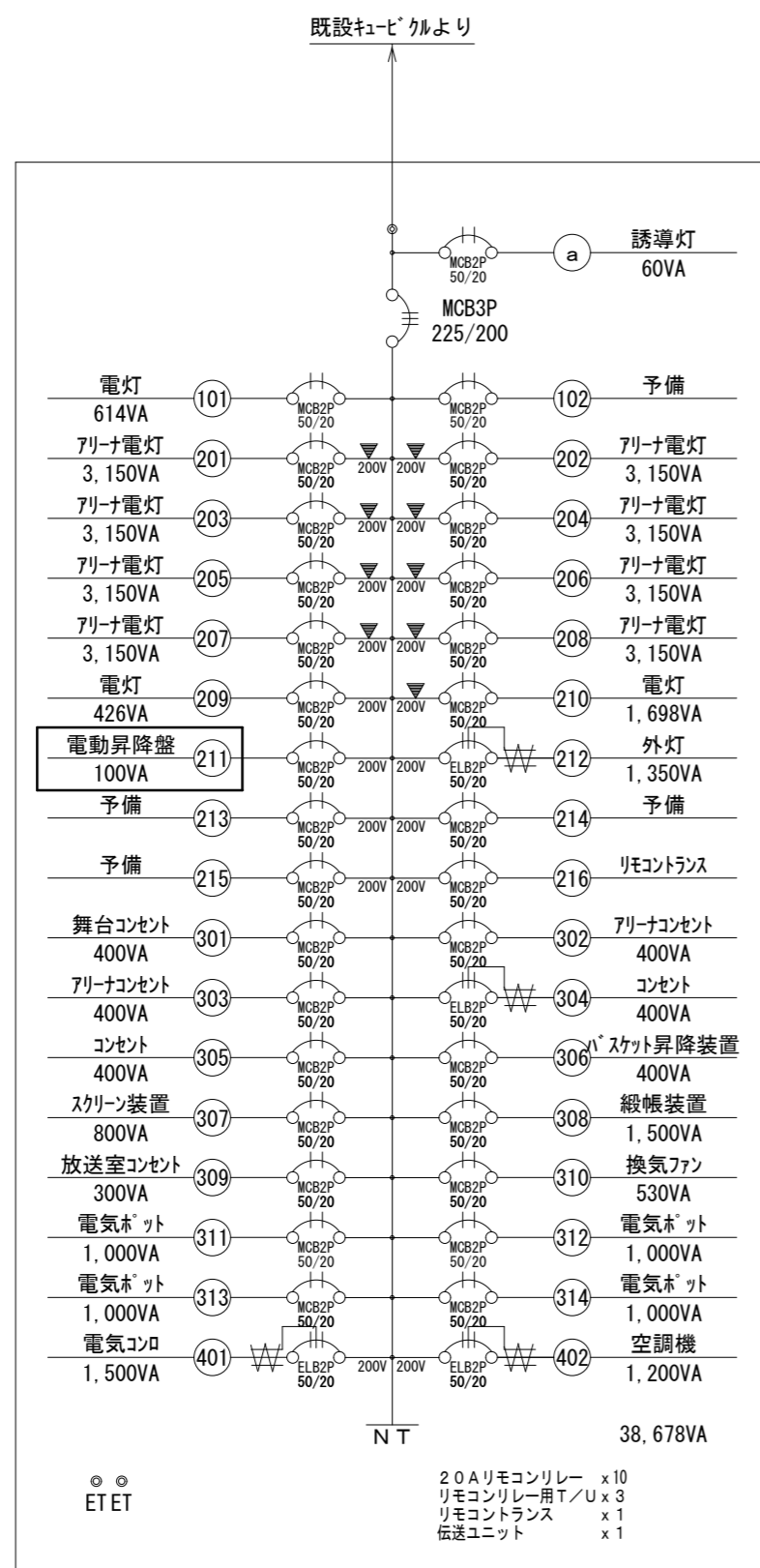
【改修前】 既設電灯盤(L-TA)
